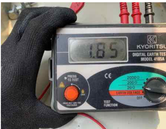
ค่าการวัดจุดต่อลงดินของกับดักไฟฟ้า (Lightning Arrester)
